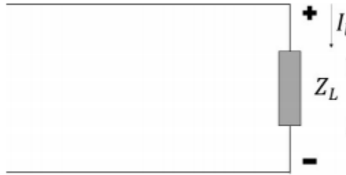
Figura 12.7: Situación al final de la línea, donde I(l) incide sobre Z_L
